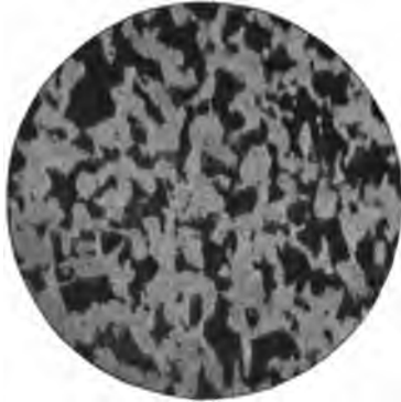
Fig. 12. Pearlite, 28 Per Cent; Carbon, 0.25 Per Cent
